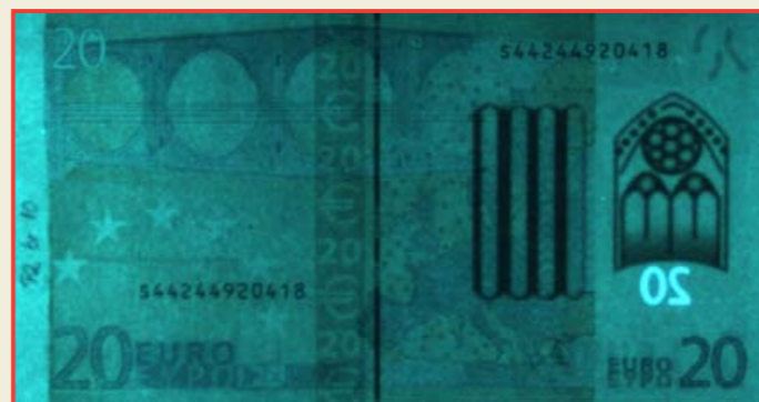
KRIVOTVORINA – verzija 1 • Papir djelomično upija UV zračenje. Fluorescentne boje i fluorescentna zaštitna vlakanca nisu imitirani. Pod UV svjetiljkom imitacije višetonskog, jednotonskog i barkod vodenog znaka vidljive su na licu i naličju krivotvorine.
