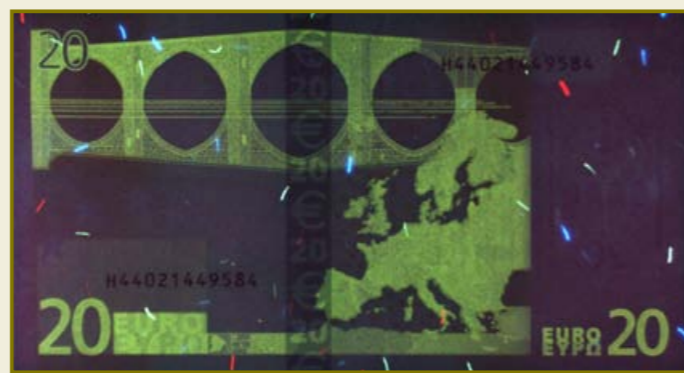
ORIGINAL • Zaštićeni papir originalne novčanice upija UV zračenje. Dijelovi crteža lica fluoresciraju narančasto i žuto-zeleno, a dijelovi crteža naličja samo žuto-zeleno. Zaštitna vlakanca fluoresciraju crveno, plavo i zeleno. Zaštitna nit i vodeni znakovi na originalnoj novčanici nisu vidljivi pod UV svjetiljkom.
