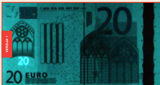
KRIVOTVORINA – verzija 1 • Papir djelomično upija UV zračenje. Fluorescentne boje i fluorescentna zaštitna vlakanca nisu imitirani. Pod UV svjetiljkom imitacije višetonskog, jednotonskog i barkod vodenog znaka vidljive su na licu i naličju krivotvorine.
